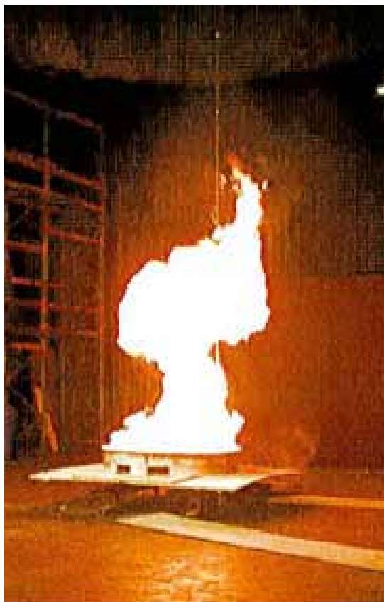
Figur 2. Brinnande Etanol E85 i ett 1,7m 2 bål. Etanol E85 brinner långsammare och ger mindre rök än bensin.
