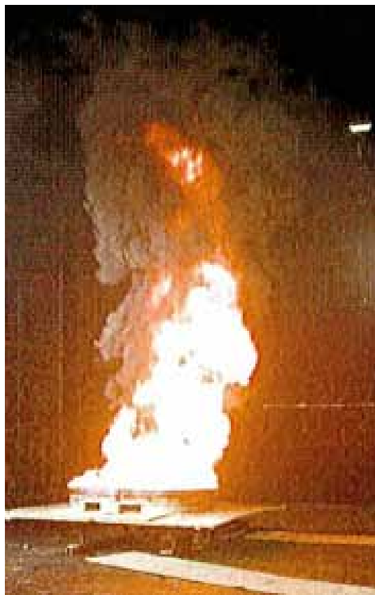
Figur 3. Brinnande bensin i ett 1,7m 2 bål ger högre flammor och betydligt mer rök än Etanol E85.
